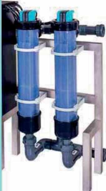
Şeffaf PVC Tüpten İmal Edilen Elektrod Hücreleri
